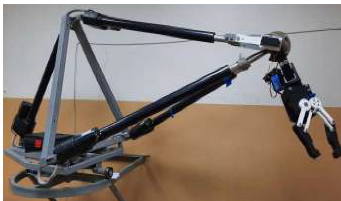
1.3-сурет – үш еркіндік дәрежесі бар антропоморфты ұстау құрылғысы бар штативті манипулятор
